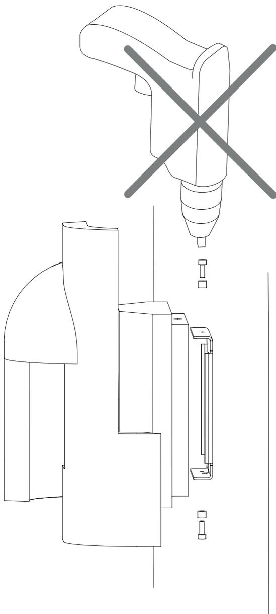
**Ne pas utiliser d'outils à main pour le serrage des vis. Les vibrations risquent de fragiliser le plâtre.**
